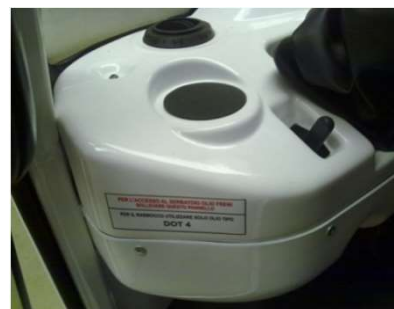
Réservoir d'huile de freins. Retirer le couvercle pour vérifier le niveau d'huile.
