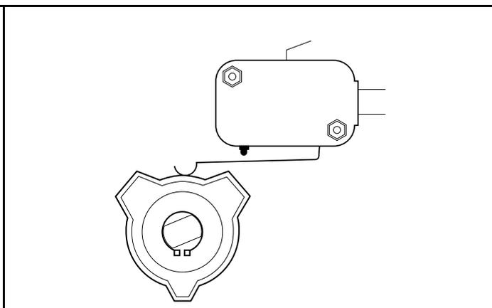
61 Figure 20 Came de verrouillage – Position de fonctionnement
