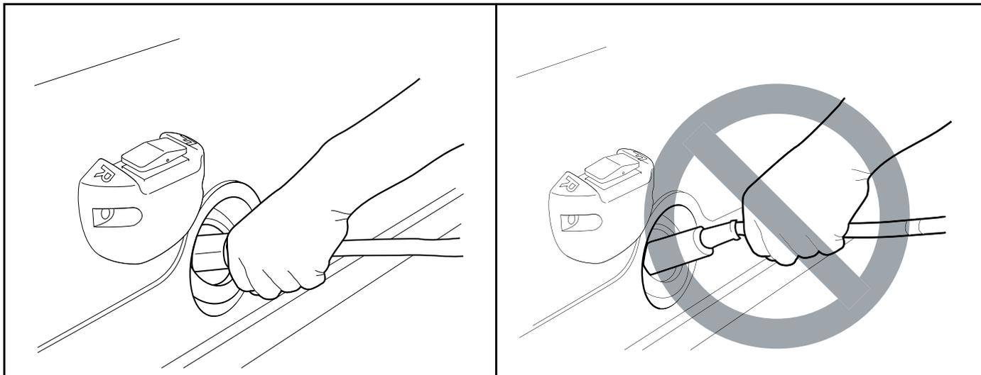
66 **Figure 28** Insertion correcte de la prise secteur du chargeur
