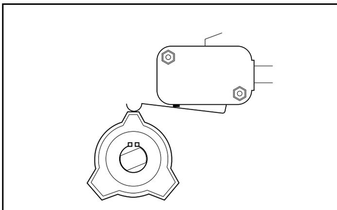
60 Figure 19 Came de verrouillage – Position d'entretien
